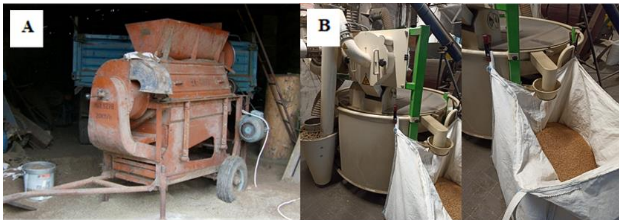
Rycina 1. Urządzenia służące do odplewiania pszenic: A – bukownik, B – profesjonalna łuszkarka.
